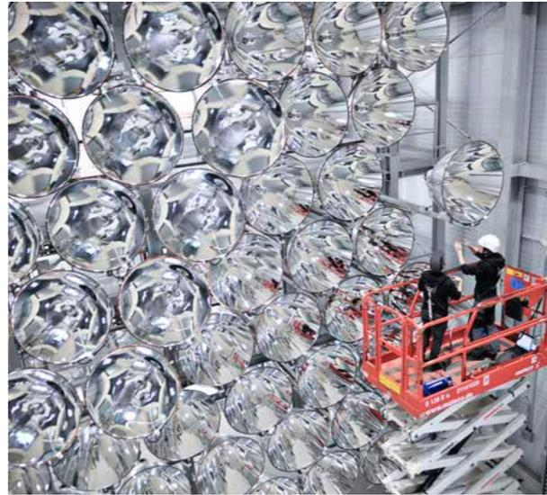
Der Hochleistungsstrahler Synlight bietet Testmöglichkeiten für die Solarchemie.
